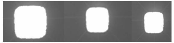
图 6 从左至右为 1、2、3 号电极对应加工的方孔照片(15×)
